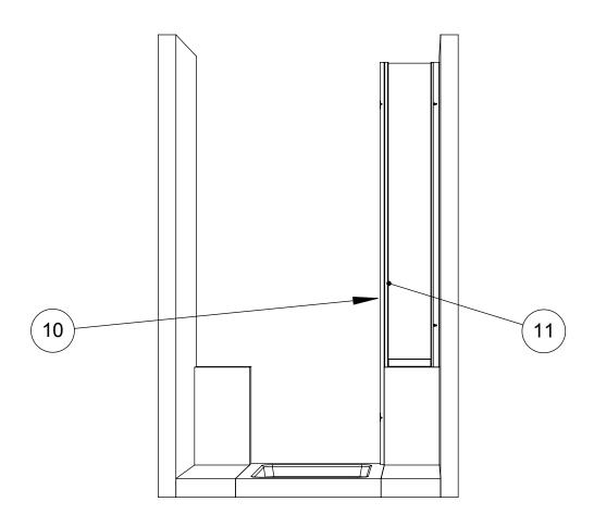
(A) FISSARE IL PROFILO (10) CON IL PROFILO (11) DELLA PARETE FRONTALE SINISTRA CON LE VITI (21) IN DOTAZIONE
