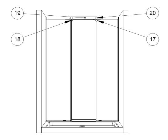
(A) MONTARE I GANCI ANTI-SCARRUCOLAMENTO (17) E (18) SULLE RUOTE E CHIUDERE CON IL PROFILO DI COPERTURA (19) FISSANDOLO ALLE RUOTE CON I DADI ESAGONALI CHIUSI (20)
