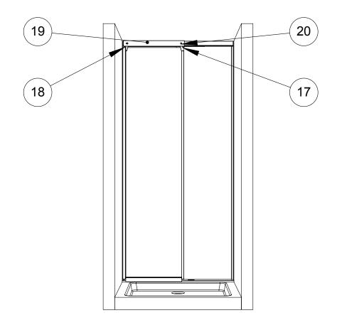
(A) MONTARE I GANCI ANTI-SCARRUCOLAMENTO (17) E (18) SULLE RUOTE E CHIUDERE CON IL PROFILO DI COPERTURA (19) FISSANDOLO ALLE RUOTE CON I DADI ESAGONALI CHIUSI (20)
